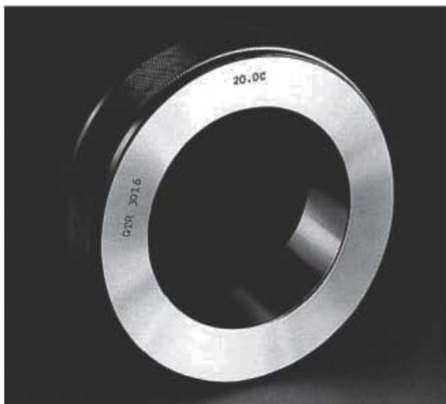
在使用带圆锥孔的双列圆柱滚子轴承NN30KR时，保证轴承内径锥度和轴的锥度一致非常重要。轴承的圆锥孔是以特定的精度来管理并加工的。锥度规《GTR30》的内径是以轴承内径同样的锥度来精密加工而成。因此，轴的锥度以锥度规为基准来加工后，可以与轴承很好地配合。
