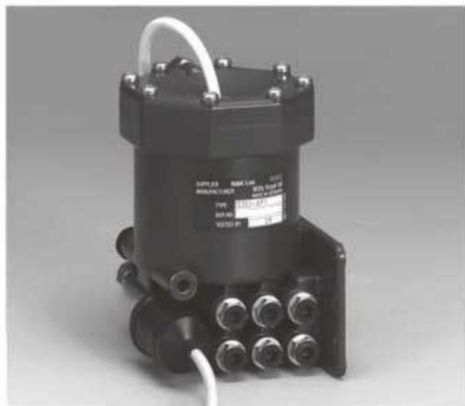
[Fine-LUB II]向高速运转的轴承进行间歇性地补给极微量的润滑脂，同时利用最佳形状的隔圈将使用过的润滑脂排到轴承座内设置的润滑脂贮藏槽处。此技术在上世界上首次实现了高速领域的脂润滑，同时还实现了长寿命。这将对脂润滑的认识全面更新、具有划时代意义的产品。
