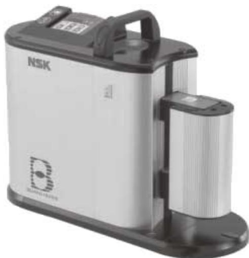
将轴承用热装方法装到轴上时，可对轴承进行快速、均匀地加热。不用加热油，可清洁地完成热装工作。不仅对轴承，也可以对齿轮等环状金属部件进行加热。
