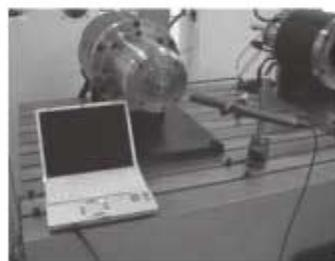
麦克风与录音器材相连接，对麦克风尽量选用具有将机械声音很好地收录下来的频率特性的麦克风。计算机自带的麦克风（内藏式）对人声的录音较合适而不适于对机械的声音进行录音，由此一般选用测量用麦克风。
