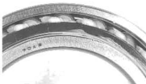
图1.19 角接触球轴承的润滑脂填充例
