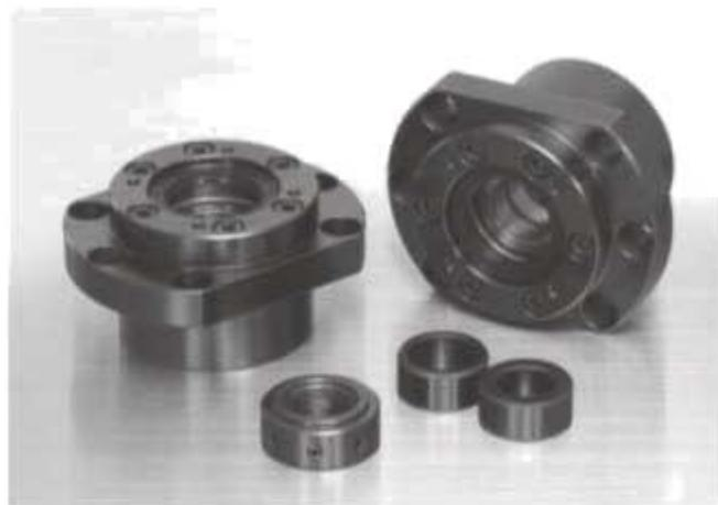
高负荷·机床用支撑单元采用的支撑轴承，是具有最佳性能与构造的高精度，高刚度滚珠丝杠支撑用推力角接触球轴承（TAC系列）。组合方式有下图所示的3种。
