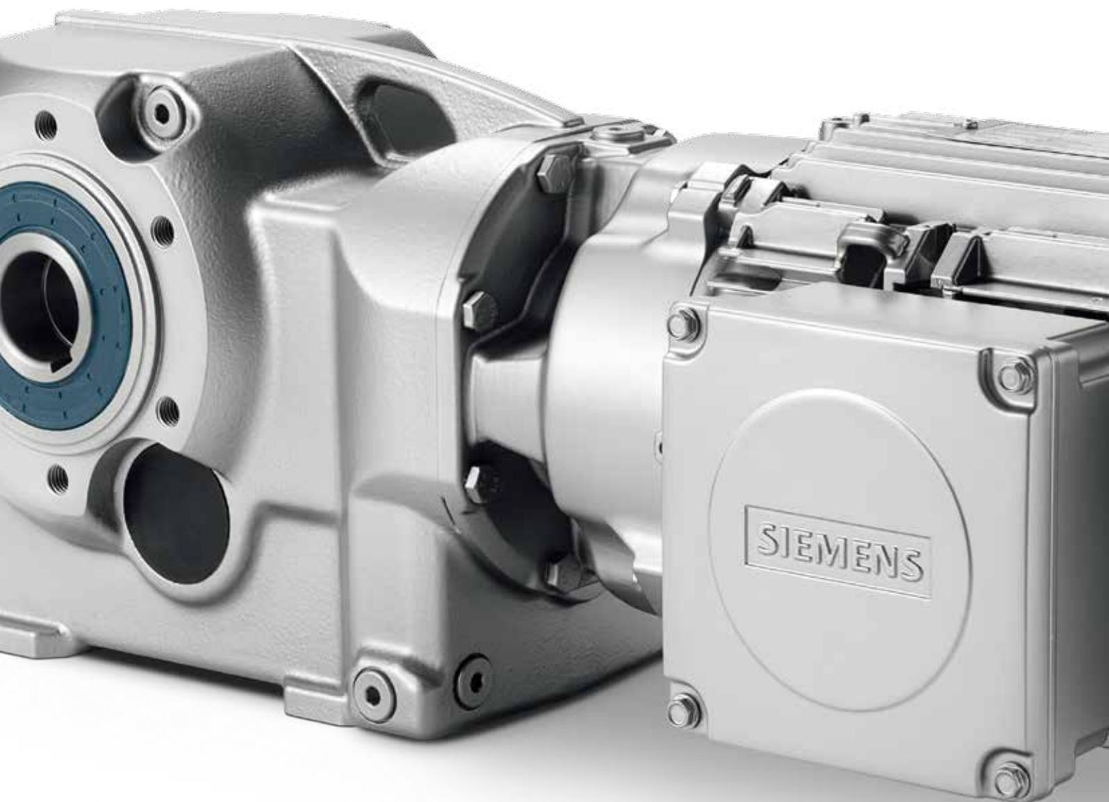
相比套入式小齿轮设计，通过采用插入式小齿轮，可实现更大速比。在很多应用中，由于省去了一个传动级，这种解决方案的性价比更高。由于具有大速比，可使用标准 4 极电机取代昂贵的 6 极或 8 极电机，显著降低成本。
