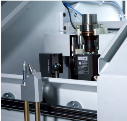
安装在刀库内的激光测量系统
