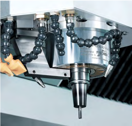
外置主轴长度补偿（高精度单元）
