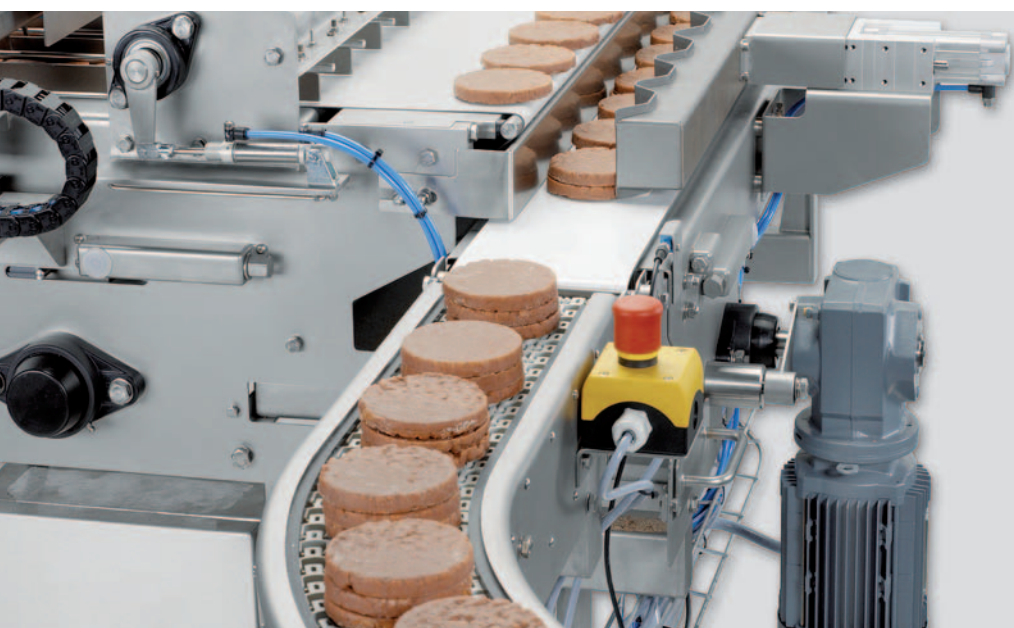
符合食品卫生安全且防腐：华夫饼机输送带系统中使用的塑料法兰轴承座单元 (图片：TMF 皮带系统 B.V.)
