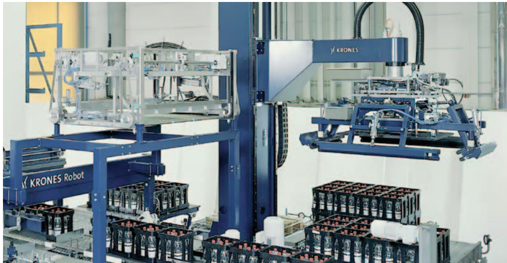
INA 直线循环滚柱轴承及导轨组件用于包装和码垛机器人，满足了制造商对于重载下的精度和长期工作可靠性的要求。（图片：KRONES）
