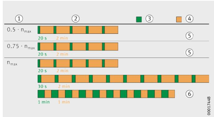
图 4 开式和密封式的主轴轴承匀脂工艺
