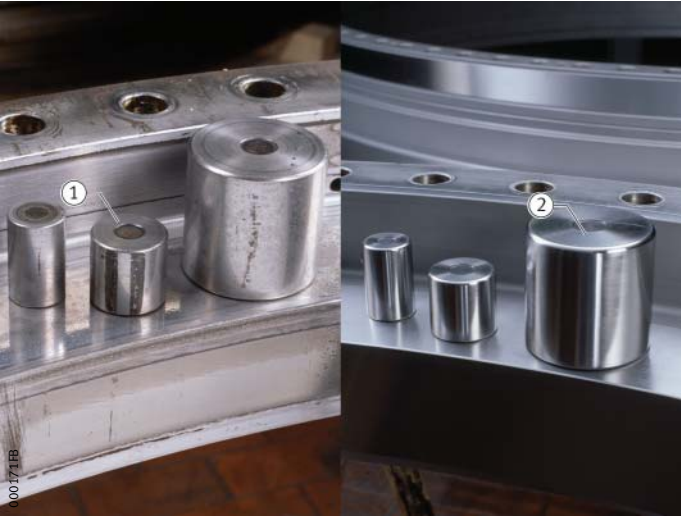
① 修复前： 滚子和滚道上有腐蚀痕迹和异形凹痕。 ② 修复后： 滚道经过重新研磨，新的滚子大小匹配
