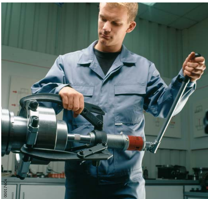
图 1 采用液压拉拔器拆卸轴承
