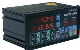
THESI系列位置控制器。在1或者2轴版本中，轴位置控制可以在手动、半自动或自动模式下进行。用户可在简单操作模式下设置常用记忆模式，储存量高达99个，每个均可以记忆20个位置99次重复。绩伟品牌位置控制器可用于无电压继电器输出，或±10 Vdc输出。其主要应用领域是金属板材切割和折弯机领域，它的多功能性也使得其可以在为数众多的领域应用。
