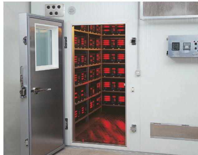
所有的仪器都是在50°C的温度下进行的，并且经过长时间的高温加工过程。在仪器内部，温度达到了70÷75°C。
