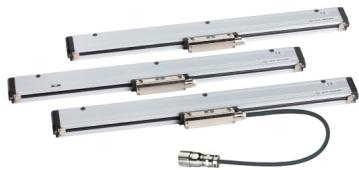
绩伟光栅尺以其精准度和稳定性著称，分为六种不同型号。ISA和SCR型号主要适用于手动机床；GVS 200系列增量式光栅尺尤其适用于同步折弯机；增量式光栅尺GVS 600主要应用于数控机床领域；绝对式光栅尺GVS 608和GVS 204主要应用高性能的机器。所有光栅尺都是在非常高的质量标准下生产的，每一根都附有度量检测报告（可从官网输入序列号进行更详细查询），从而保障产品能在极端的环境和气候下仍能保持高质量和稳定性。
