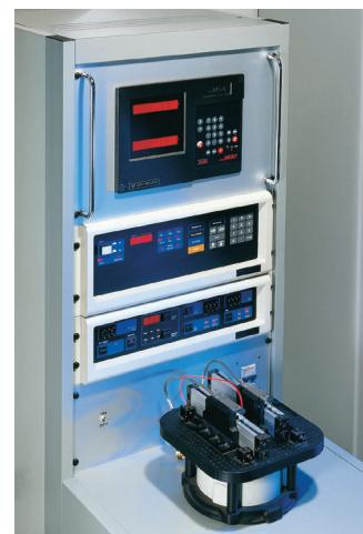
在设计和样机制造阶段，这些仪器在受到极端的加速度、振动和温度的情况下进行不间断地监测它们的功能、位移、振幅和信号的质量。
