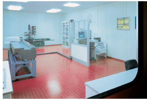
度量室：绩伟光栅尺和磁栅尺均在严格的环境和温度条件下进行测试: T = 20°C ± 0.1°C    R.H. = 45 ÷ 55 %
