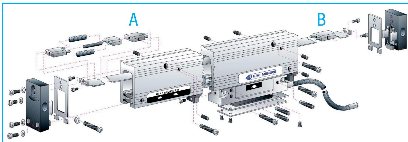
光栅线性延伸的自调节。压缩弹簧可以抑制阻尼A和阻尼B之间的距离保持不变。固定在尺罩内的弹簧可以根据热膨胀系数变化。光栅可以根据线性热膨胀系数自由膨胀，这与生产机器和其他控制装置所使用的材料一样。在加工过程中，相对于20°C(68°F)的温度来说，测量值是均匀的。
