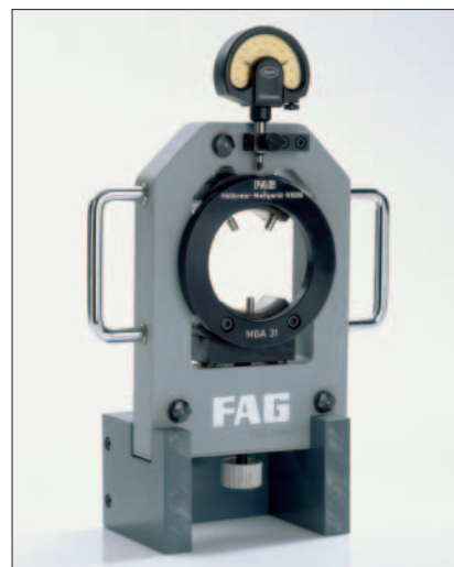
FAG包络圆测量仪MGI 31用于调整具有可分离内圈的圆柱滚子轴承的径向游隙或预载
