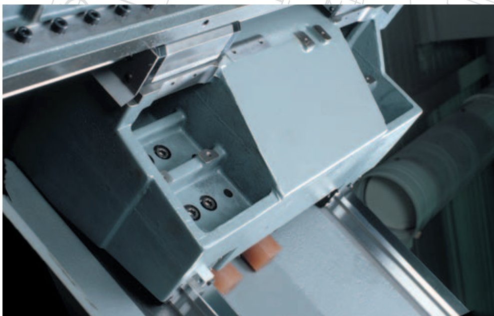
RUE..E 直线滚柱导引系统为机床的引导轴机构提供了可靠保证
