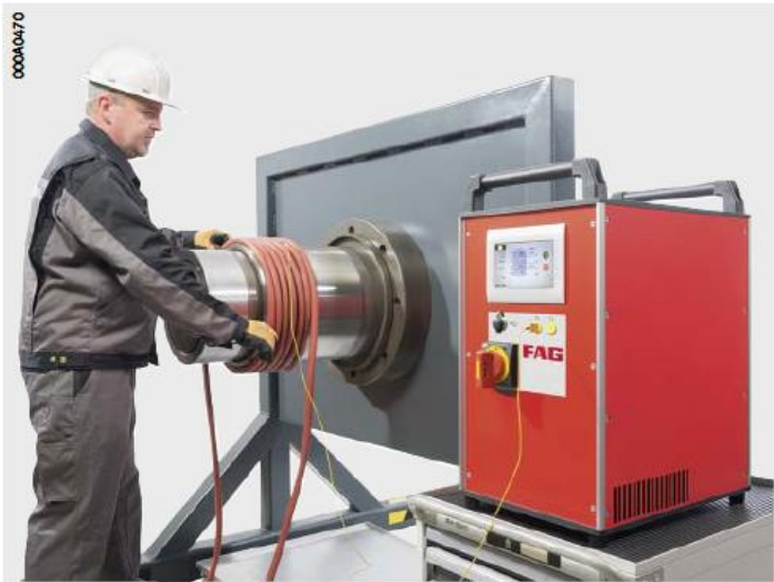
图1 柔性感应线圈可缠绕在工件上 柔性感应线圈
